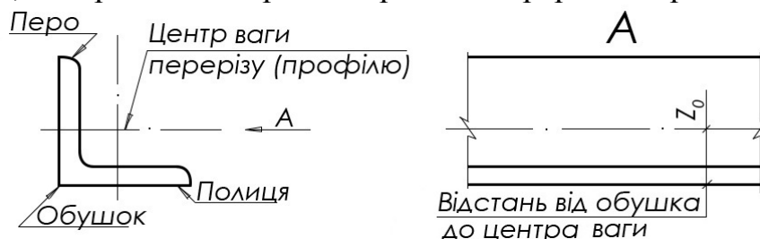
Рисунок 15– Нанесення відстані від обушка до центра ваги
