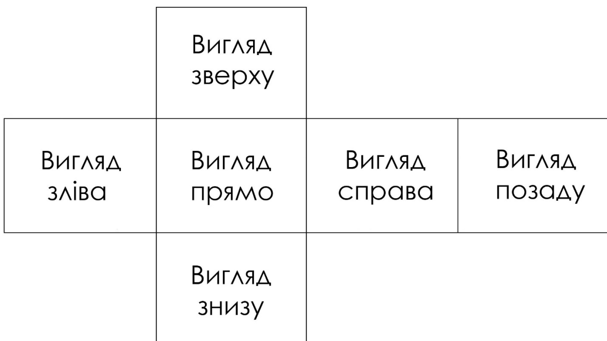
Рисунок 6 – Прийняте розташування виглядів на кресленнях металоконструкцій
