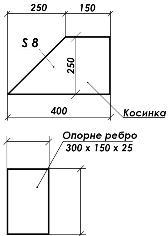
Рисунок 19 – Приклад креслення косинки і опорного ребра.
