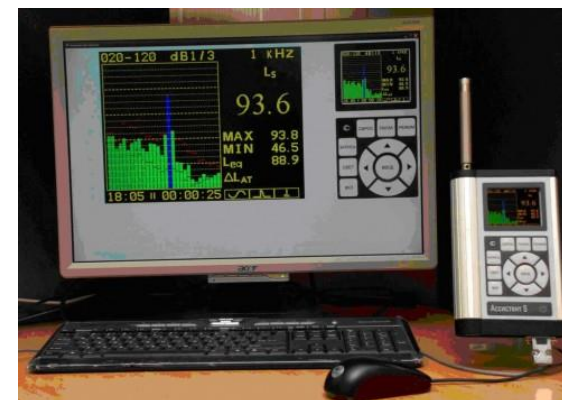
Вимірювач шуму та вібрації ВШВ-003
