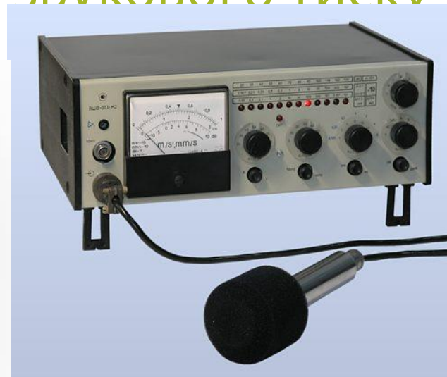
Вимірювач шуму та вібрації ВШВ-003
